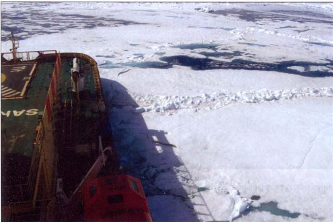
Рис. 3. Торосистые образования при движении кормой на режиме № 5
